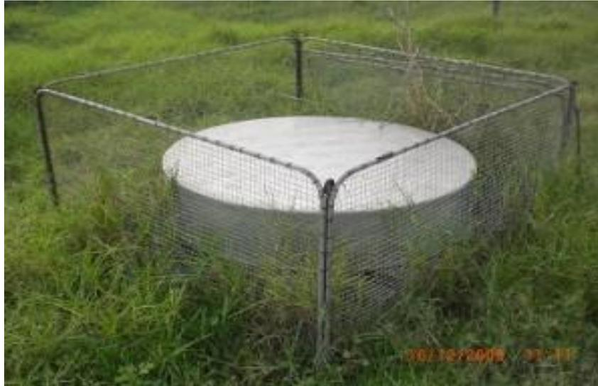
**Figure 11: Photo montrant un bac d'évaporation**
