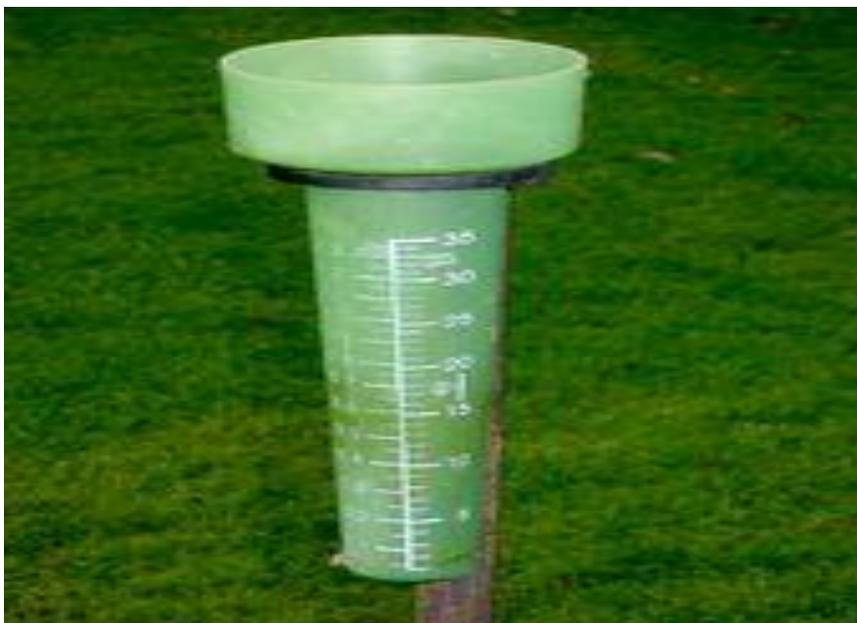
Figure7 : photo d'un pluviomètre
