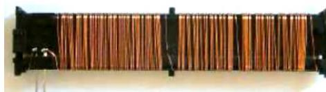
Figure 4.8. Antenne ferrite
