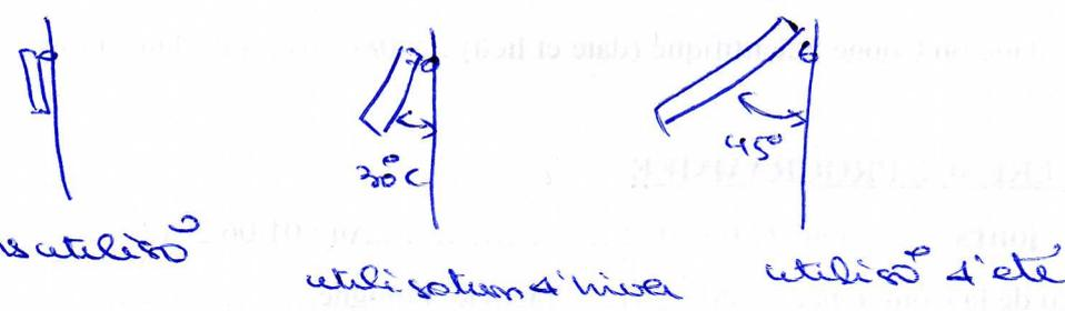
Fig : châssis support de modules sous # positions permet de s'adapter à la saison
