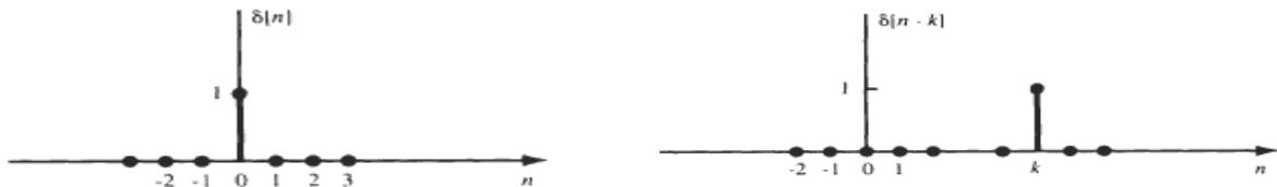
**Figure 6.1** : La séquence impulsion unité et sa version décalée
