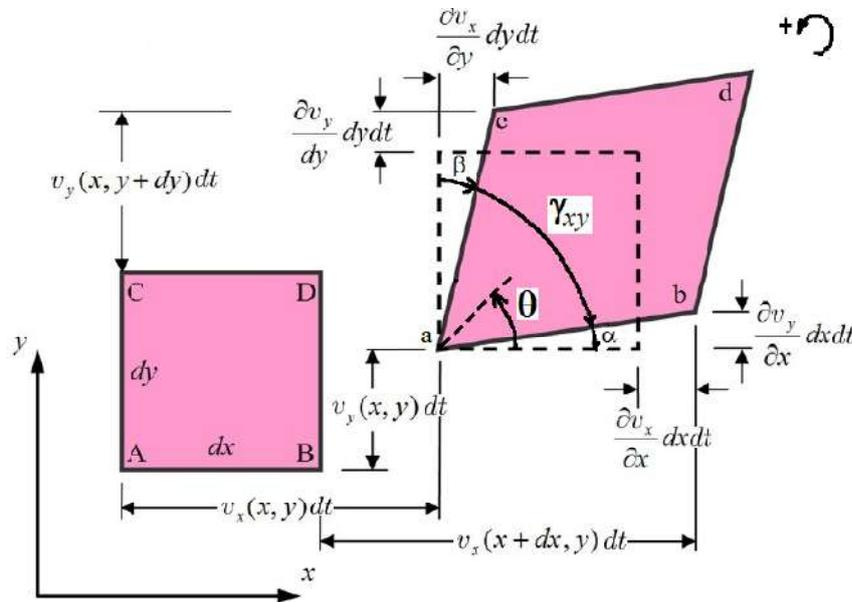
Figure 4 : Différentes déformations : translation, expansion, cisaillement, rotation
