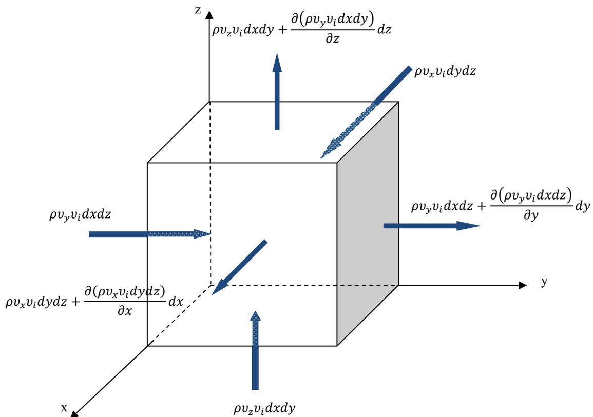
**Figure 1 :** Les flux de quantité de mouvement suivant  $x_i$  à travers les faces
