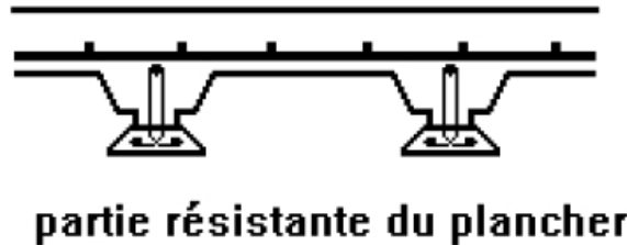
Figure 6 : partie résistante du plancher
