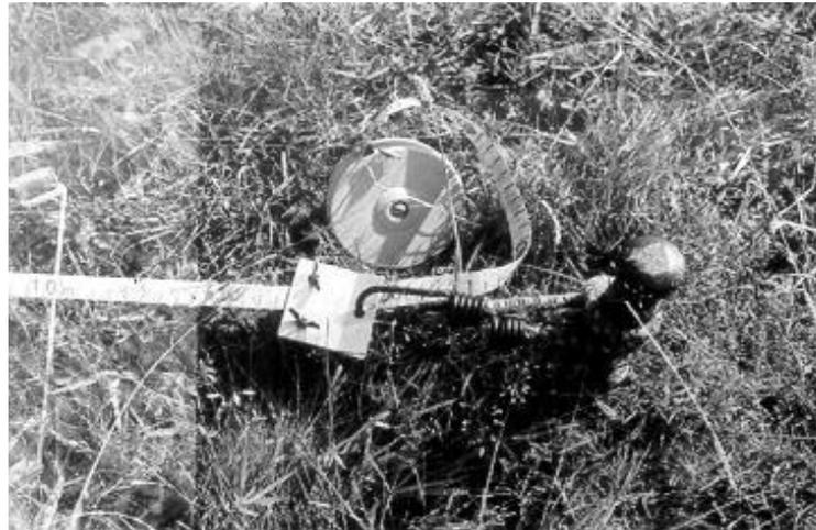
Mode de fixation du double décimètre utilisé pour la méthode des segments contigus
