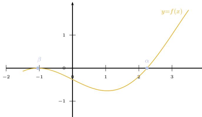
La méthode de la bisection ne peut-être appliquée pour approcher  $\beta$  car la fonction  $f$  ne change pas de signe dans son voisinage. De l'autre côté, le graphique montre que  $\alpha \in [a, b]$  avec  $a = \frac{3}{2}$  et  $b = 3$  (et nous pouvons vérifier que  $f(a)f(b) < 0$ ) et donc, l'erreur correspondante à  $\alpha$  satisfait
