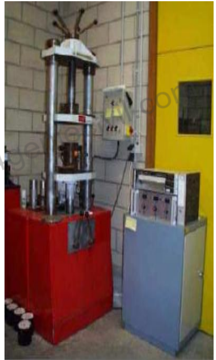
Essai d'immersion compression LCPC à 18°C [5]
