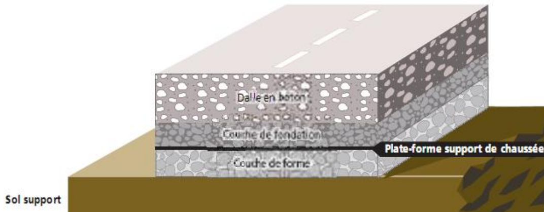
Fig 1.10. Structure type d'une chaussée rigide [9]
