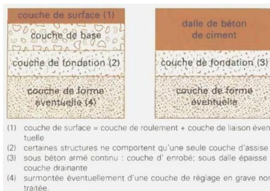
Fig .4.1. Structure type de chaussée[42]
