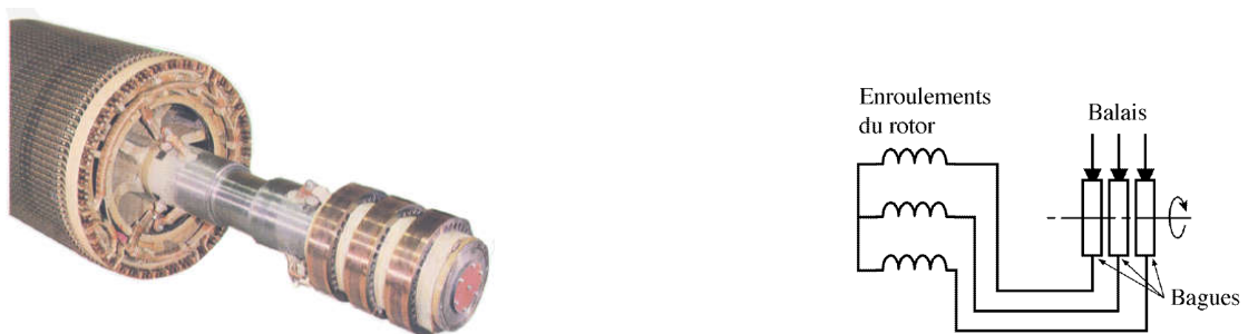
Figure 3.9. Rotor bobiné d'un moteur asynchrone.
