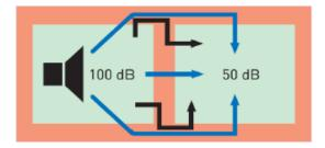
L'expérience montrant que Db est indépendant de la puissance de la source, mais qu'il varie avec forme du spectre du bruit émis, les mesures se font par bandes de fréquences (octaves ou tiers d'octave).
