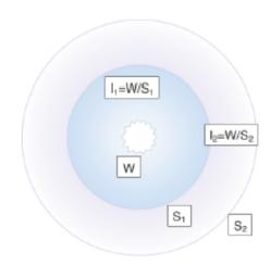
Plus on s'éloigne d'une source, plus la surface de l'onde (traversée par la même puissance acoustique émise par la source) grandit, et plus l'intensité reçue diminue.
