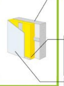
Exemple de performance acoustique pour une cloison double en briques creuses (1 x 200 mm) et plaque de carton plâtre (1 x 12 mm) vissés sur fourrures avec isolant en laine de verre semi-rigide 100mm. Source :PV CSTB AC 02-127, source schema : Isover
