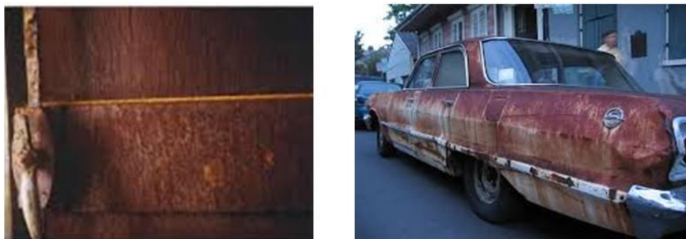
Figure I-4 : Corrosion généralisée : exemple d'une d'une porte et d'un véhicule corrodés.
