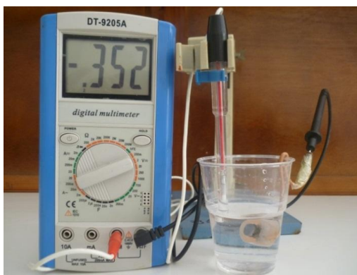
Figure III-15 : Exemple de montage utilisé pour la mesure du potentiel à circuit ouvert
