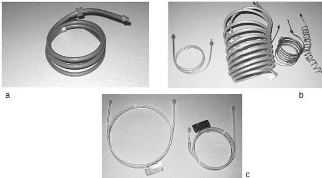
**Fig.4** Photo colonnes remplies a) Cuivre
