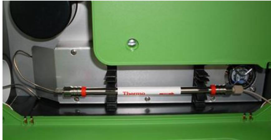
**Fig. 1.5** Colonne dans un thermostat
