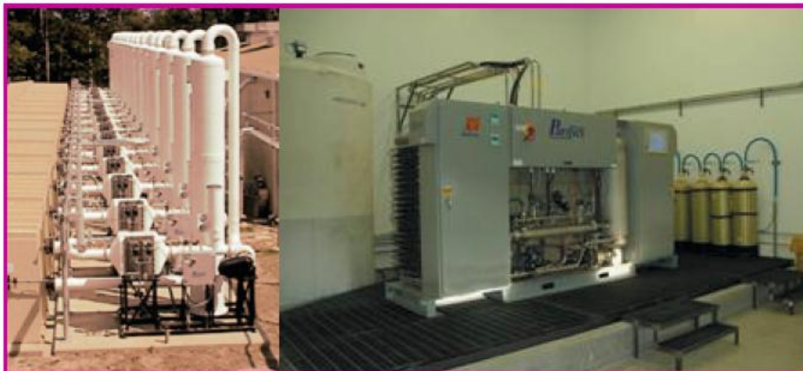
Figure IV.2 : Dispositif photocatalytique pilote Photo-Cat proposé par la société Purifics.
