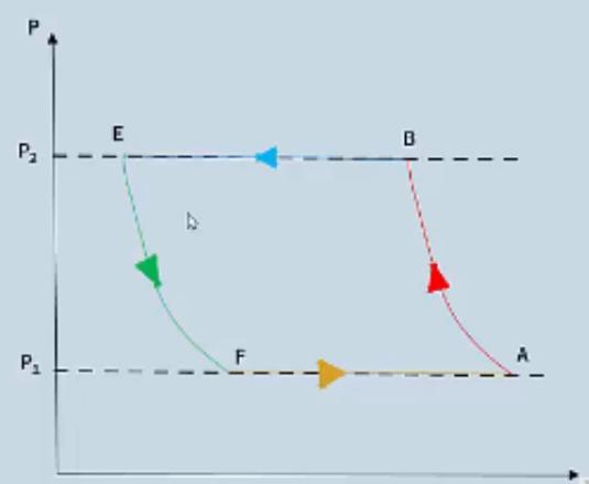
3. La chaleur échangée par le gaz au cours d'une transformation isobare est égale à sa variation d'enthalpie entre les états initial et final, or l'enthalpie d'un gaz parfait ne dépend que de sa température (deuxième loi de Joule). Pour la transformation F  $\rightarrow$  A dans l'échangeur E<sub>1</sub>,  $Q_1 = mC_p(T_1 - T_4)$  et pour la transformation B  $\rightarrow$  E dans l'échangeur E<sub>2</sub>,  $Q_2 = mC_p(T_2 - T_3)$
