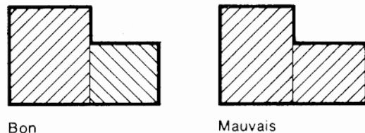
Dans les dessins à petite échelle ou pour les pièces de faible épaisseur, on remplace les hachures par un pochage au crayon ou à l'encre. On doit dans ce cas ménager un léger blanc entre les pièces contiguës.
