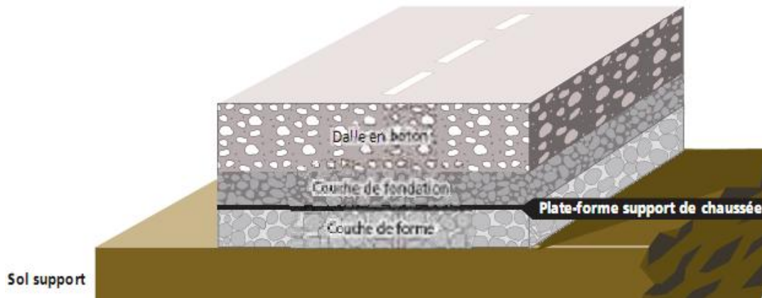
Fig 1.10. Structure type d'une chaussée rigide [9]
