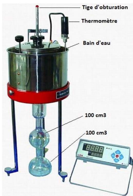
Fig .3.9. Mesure du temps d'écoulement par viscosimètre d'Engler (modifié de : http://www.cqtestkit.com/products.asp?sid=31&id=20 )
