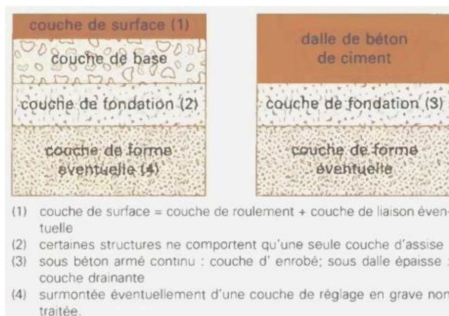
Fig .4.1. Structure type de chaussée[42]
