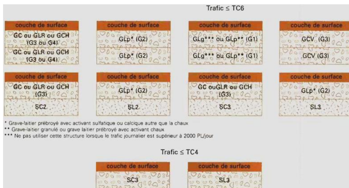
Fig .4.3. Structures à assises traitées aux liants hydrauliques de référence[42]
