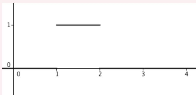
On calcule alors la transformée de Laplace de cette fonction soit en utilisant la transformée de Laplace de la fonction échelon-unité et le théorème du retard, soit en utilisant l'expression de la fonction déterminée ci-dessus.
