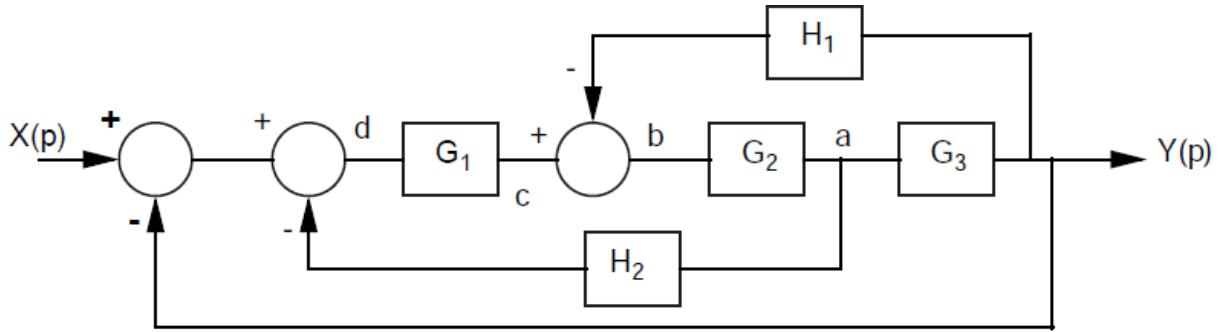
Simplifier ce **schéma fonctionnel** et en déduire la **fonction de transfert** du système.
