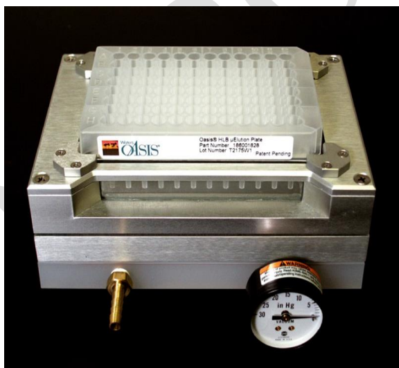
Figure I.15. Système d'extraction en phase solide pour plaque 96 puits. Source : Waters Corporation.
