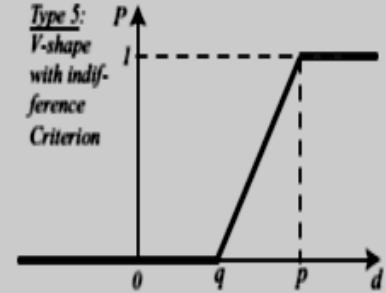
$$P(d) = \begin{cases} 0 & d \leq q \\ \frac{d-q}{p-q} & q < d \leq p \\ 1 & d > p \end{cases} \quad p, q \quad d = a_{ij} - a_{kj}$$
