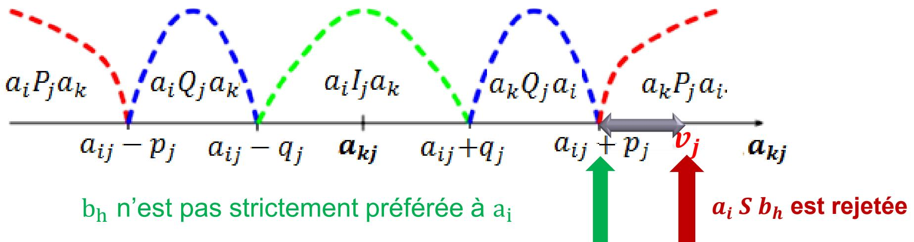
$$D_j(a_i, b_h) = \begin{cases} 0 & \text{si } b_{hj} < a_{ij} + p_j(b_h) \\ 1 & \text{si } b_{hj} > a_{ij} + v_j(b_h) \\ \frac{a_{ij} + p_j(b_h) - b_{hj}}{p_j(b_h) - v_j(b_h)} & \text{sinon} \end{cases}$$
