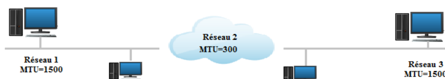
Figure 6.4 Exemple de MTU
