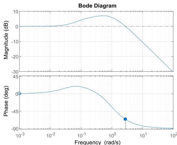
$$\begin{aligned} \omega_{c0} &= 2.8 \text{ rad/s} & M\varphi_1 &= 114^\circ & \rightarrow \text{système stable} \\ \omega_{-\pi} &= \text{non définie} & MG1 &= \infty \end{aligned}$$
