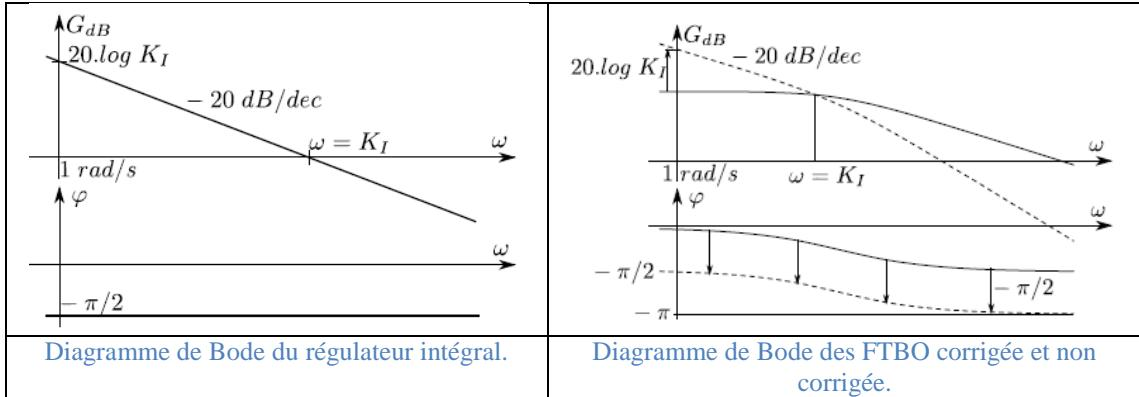
On remarque des diagrammes de Bode de la FTBO corrigée que l'amplification infinie des basses fréquences permet d'assurer la précision du système.
