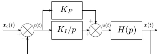
Le diagramme de Bode de ce régulateur nous montre qu'il ne diminue plus la phase pour  $\omega \gg \frac{K_I}{K_P}$ . Il amplifie toujours les basses fréquences ce qui assure la précision.
