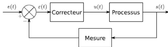
Le régulateur est présent pour adapter les performances du système lorsque celui-ci présente des défauts et qu'il ne respecte pas les critères du cahier des charges. À chaque défaut, une régulation est adaptée. Par exemple:
