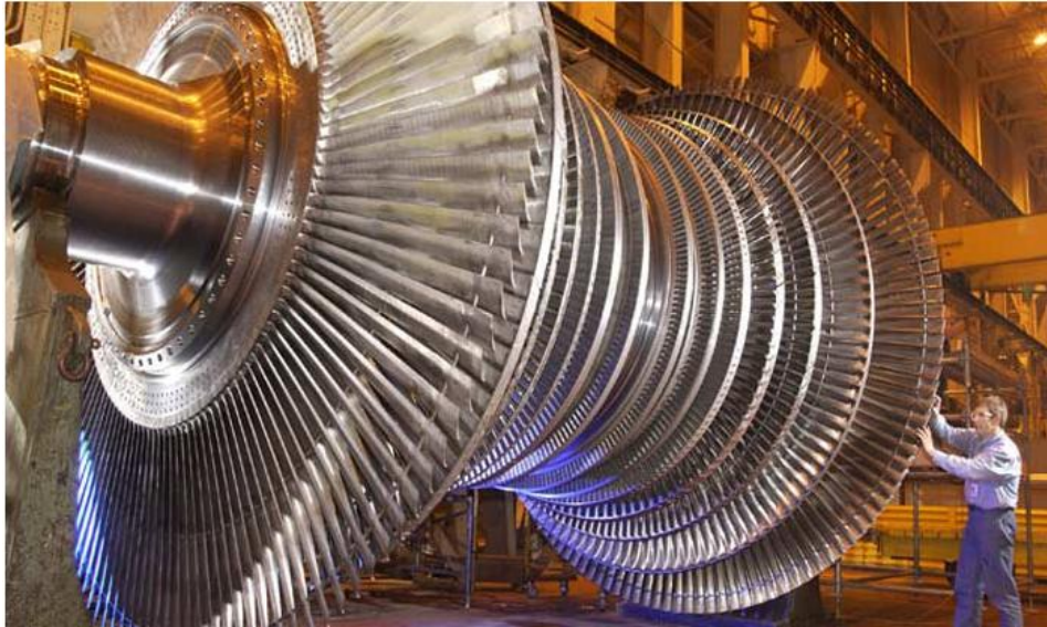
Fig. 5 : rotor d'une turbine utilisé dans une centrale thermique
