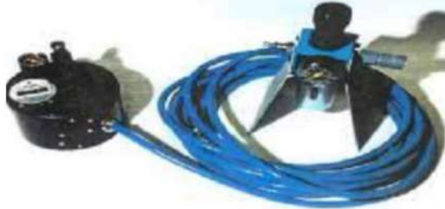
Fig.7.5 : Le dispositif d'inspection sous vide d'airbus[53]
