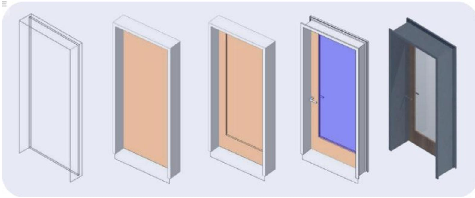
La maquette numérique, également appelée modèle BIM, est une représentation virtuelle d'un bâtiment ou d'une infrastructure. Elle contient non seulement des informations géométriques, mais aussi des données sur la structure, les matériaux, les coûts, la planification, et bien plus encore. Pour exploiter pleinement le potentiel du BIM, il est essentiel de comprendre les niveaux de détail, d'information et de développement.
