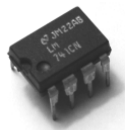
figure 2 : Circuit intégré d'un AO
