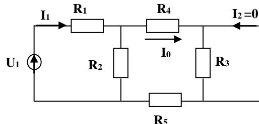
En utilisant le pont diviseur de courant, on obtient la valeur de  $I_0$  :
