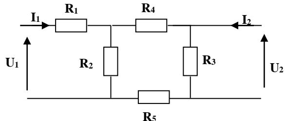
➤ On ouvre les bornes de la sortie :  $I_2 = 0$  (sortie en circuit ouvert)
