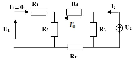
$$I'_0 = \frac{R_3}{R_3 + R_2 + R_4 + R_5} I_2$$
