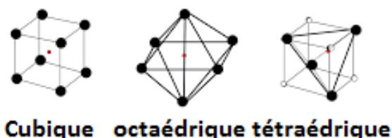
Les éléments les plus courants qui occupent les sites interstitiels dans la ferrite et l'austénite sont le carbone et l'azote de diamètres 0.8 et 0.7 Å, respectivement. Il faut noter que la dissolution de ces éléments ne peut excéder respectivement 1.7 et 2.8% en poids dans l'austénite (CFC). Dans la ferrite (CC), l'insertion de ces éléments est privilégiée sur le site octaédriques aux positions (0,0,1/2). La solubilité du carbone est limitée alors à 0.02% en poids.
