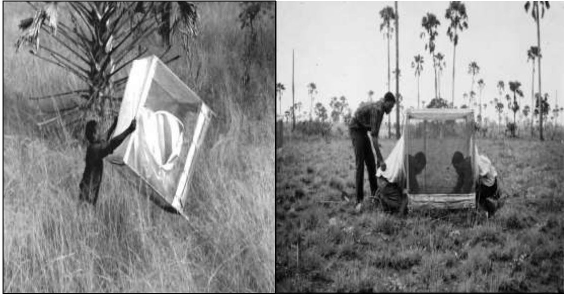
Figure 02. Cage de récolte sans fond mise en place (Gillon, 1967).
