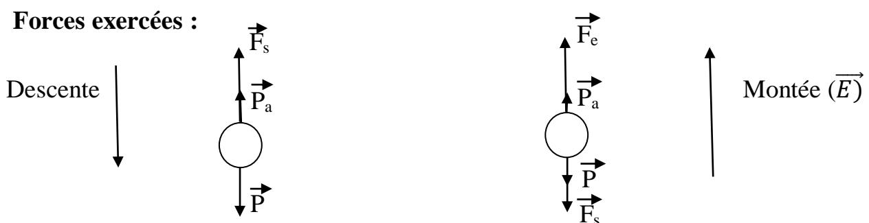
Ainsi, Millikan a pu suivre plusieurs gouttelettes avec différentes charges  $q_1, q_2, q_3, \dots, q_n$ , avec différentes vitesses,  $v_1, v_2, v_3, \dots, v_n$ . Il a pu constater que les valeurs de  $q$  étaient toujours des multiples entiers d'une certaine valeur  $q_0$  qui est la plus petite charge électrique que peut porter une gouttelette d'huile.  $q_0$  est la charge électrique élémentaire  $e$ , où  $e = 1,602 \times 10^{-19} \text{ C}$ .
