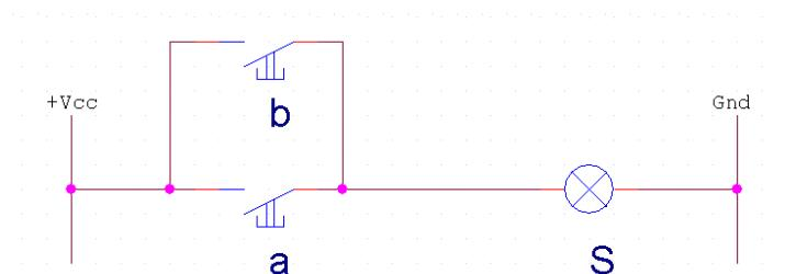
Au repos, la lampe est éteinte; La lampe s'allume si l'on appuie sur a **ou** sur b. On est donc en présence d'une fonction OU.
