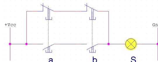
Au repos, la lampe est allumée; La lampe s'éteint si l'on appuie sur a ou sur b, mais elle s'allume si l'on appuie sur les deux.
