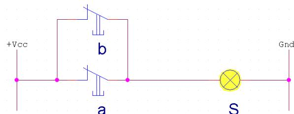
Au repos, la lampe est allumée; La lampe s'éteint si l'on appuie sur a et sur b. On est donc en présence d'une fonction NON ET.
