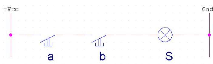
Au repos, la lampe est éteinte; la lampe s'allume seulement si l'on appuie sur a **et** b. On est donc en présence d'une fonction ET.
