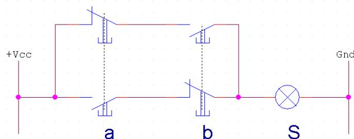
Au repos, la lampe est éteinte; La lampe s'allume si l'on appuie sur a ou sur b, mais elle s'éteint si l'on appuie sur les deux. En résumé  $S=1$  si et seulement si l'on appuie exclusivement sur a ou sur b. On est donc en présence d'un OU exclusif.
