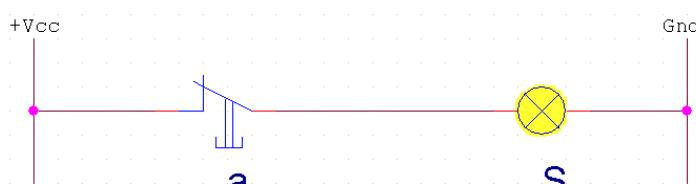
Au repos ( $a=0$ ), la lampe est allumée ( $S=1$ ) ; si on appuie sur  $a$  ( $a=1$ ), la lampe s'éteint ( $S=0$ ); On peut donc écrire  $S=\bar{a}$ . Donc un contact repos représente le complément de la variable.
