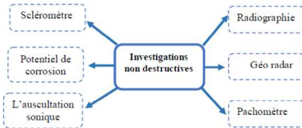
Figure III.1 : Schéma des auscultations non destructives
