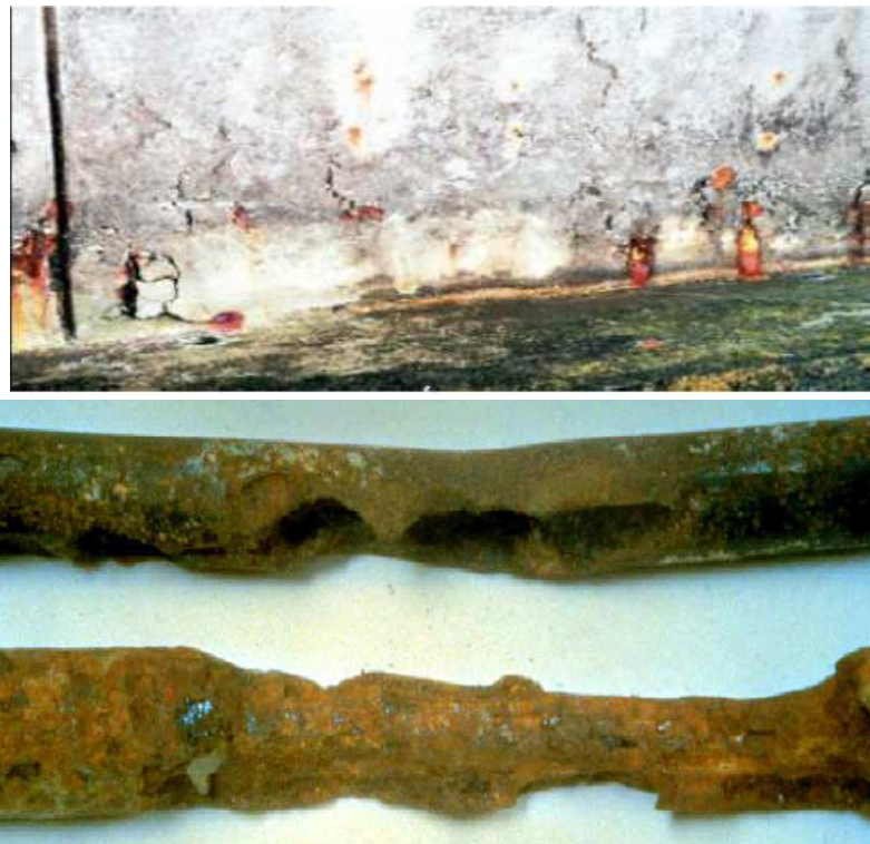
Figure I.7 : Piqûre causée par une attaque de chlorure
