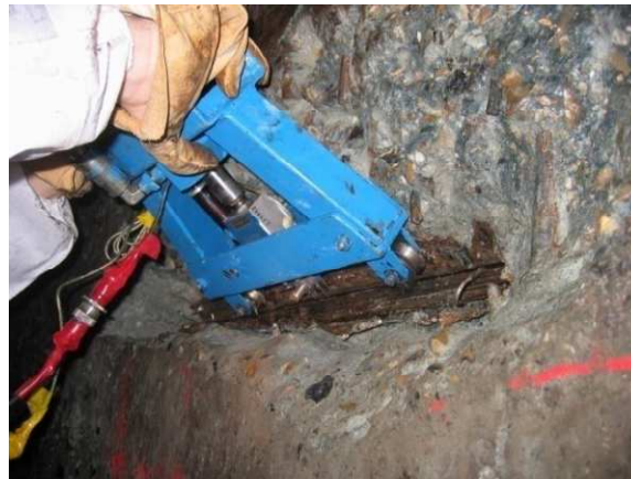
Figure III.13 : la méthode de l'arbalète et son application sur site
