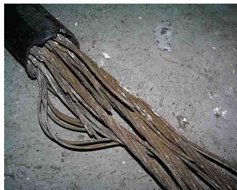
Figure II.6: déformations des gaines et rupture de câbles dans un béton précontraint
