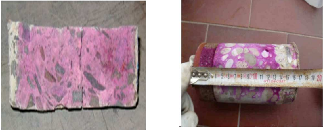
Figure 1.5: phénomène de la carbonatation
