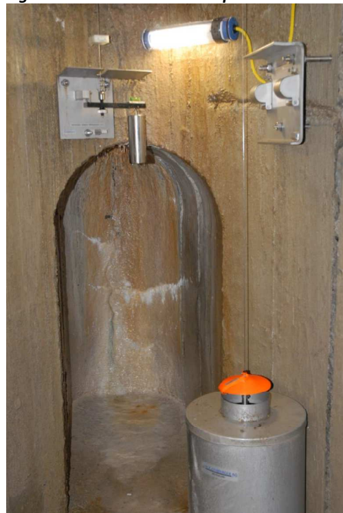
Figure III.10 : Pendule direct et distancemètre vertical
