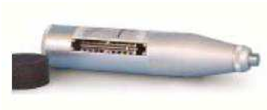
Figure III.1 : Le scléromètre sur une paroi de béton
