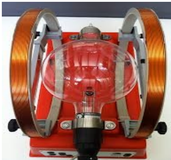
Figure 4.2: Ampoule à vide électronique et les bobines de Helmholtz associées.
