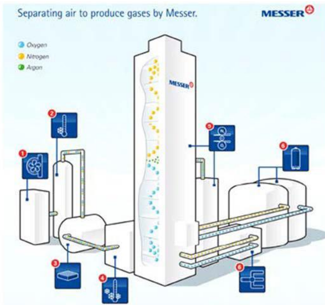
Figure 9: les étapes de bases de séparation cryogénique de l'air
