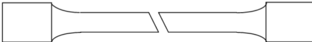
Figure 5a : Rupture fragile : schématisation
