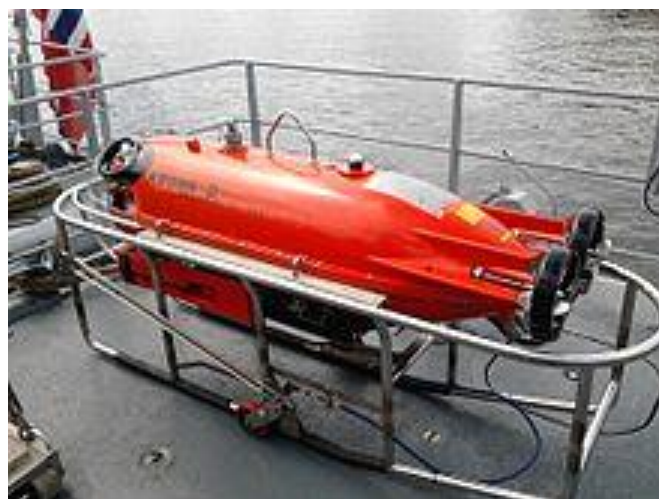
AUV pour l'identification des mines et leur destruction (KNM Hinnøya en 2012).
