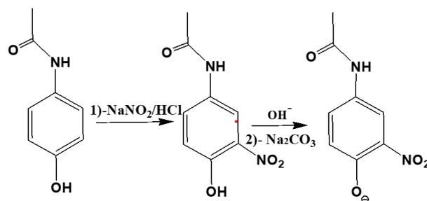
Le mécanisme réactionnel est toujours soumis à débat. Pour simplifier, on suppose qu'il s'agit d'une substitution électrophile suivie d'une oxydation. L'excès des ions nitrite est ensuite éliminé par réaction avec l'acide sulfamique ( $\text{H}_2\text{NSO}_3\text{H}$ ).
