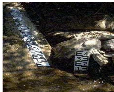
Echelles métriques en relai le long de la berge
