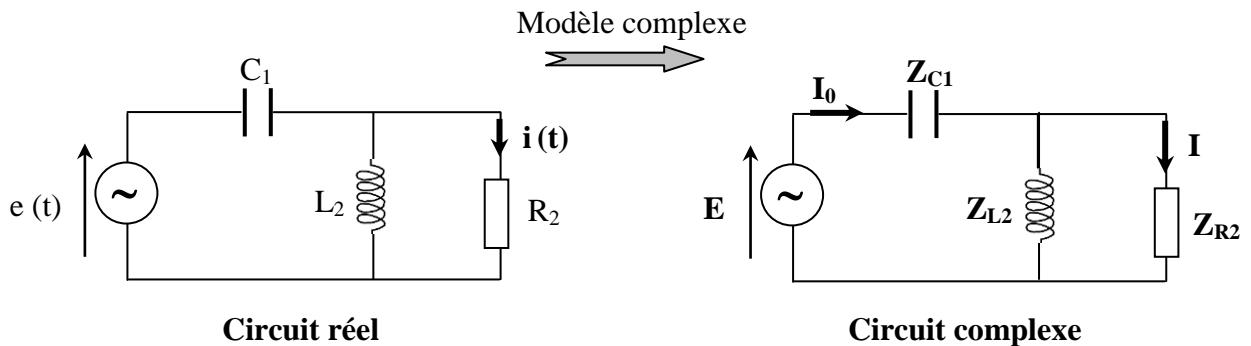
$$\text{Tel que : } Z_{R2} = R_2 \quad ; \quad Z_{C1} = -\frac{j}{C_1 \omega} \quad ; \quad Z_{L2} = jL_2 \omega$$
