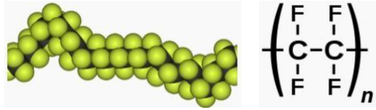
Fig. 3.4 Structure du PTFE.
