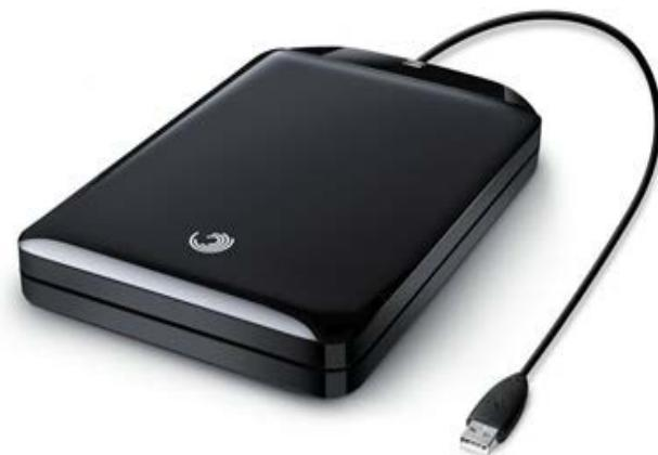
Techniquement, un disque dur externe, est généralement un disque dur (interne) placé dans un boîtier lui permettant d'être branché sur un des ports d'entrée-sortie de la carte mère.
