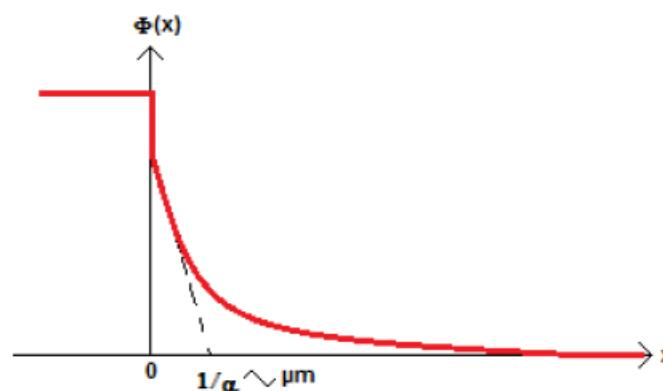
On peut considérer le coefficient d'absorption comme pratiquement constant et voisin de  $10^6 \text{ m}^{-1}$  si  $E$  supérieur à  $E_g$  (il est nul sinon), L'effet du flux sur la création de porteurs se fait sentir sur quelques  $\mu\text{m}$ .
