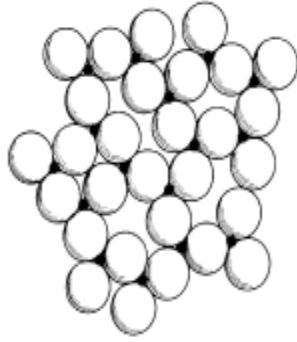
Structure amorphe du verre de silice
