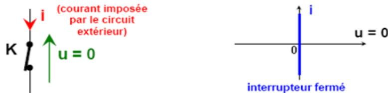
On note donc que pour un **interrupteur idéal**, la **caractéristique statique est non dissipative**.
