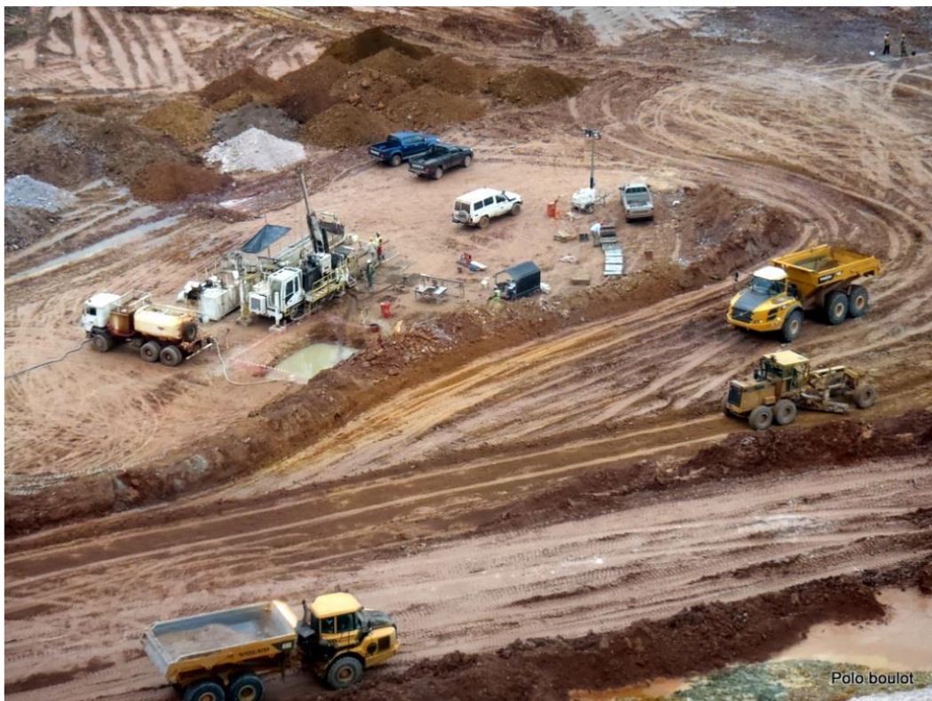
Figure 02 : Aménagement d'une plate-forme de sondage en mine à ciel ouvert
