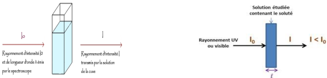
Schéma de principe de lecture d'un échantillon en spectroscopie UV-visible
