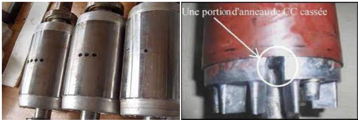
Fig. III.5 : Cage d'écureuil : (a) défaut de barres ; (b) défauts d'anneau
