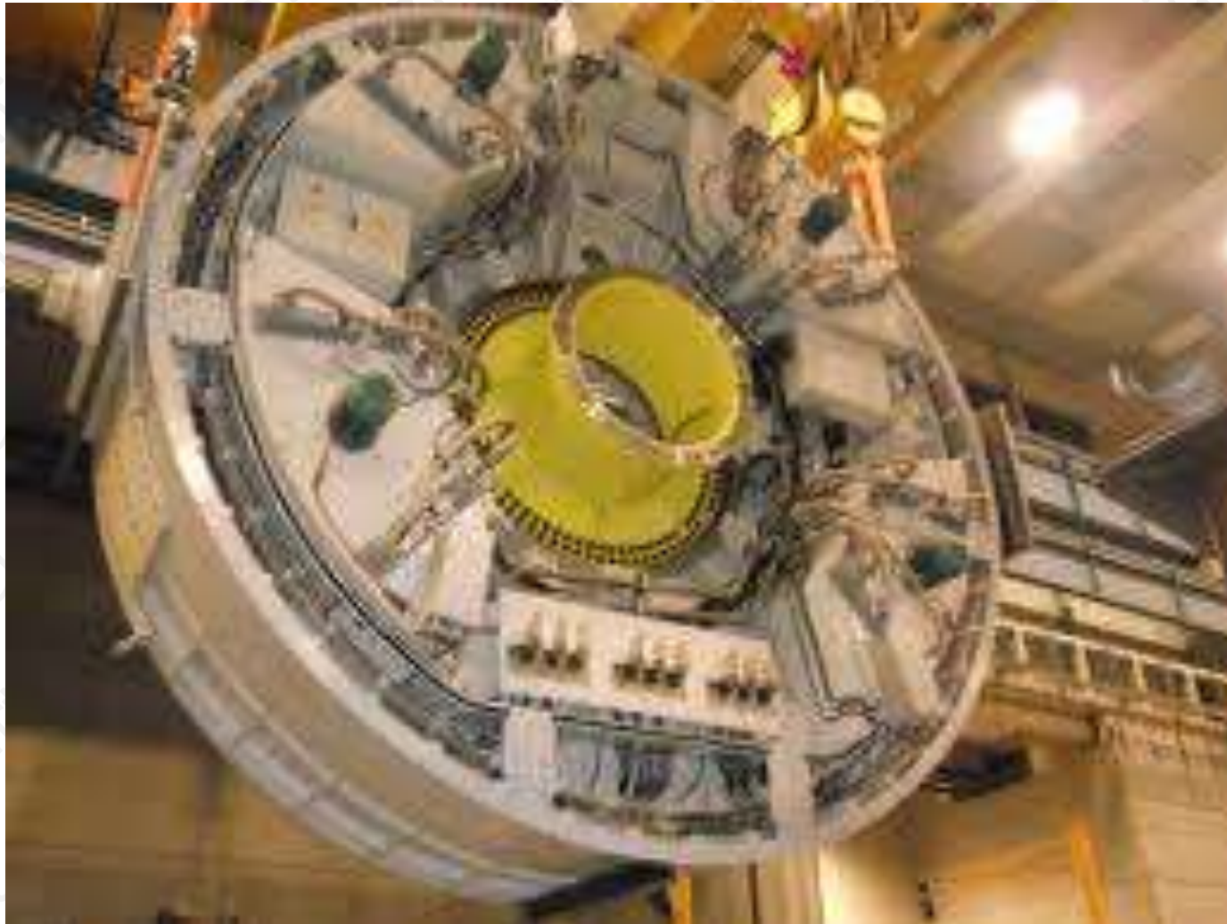
Alternateur à attaque directe à aimants permanents
